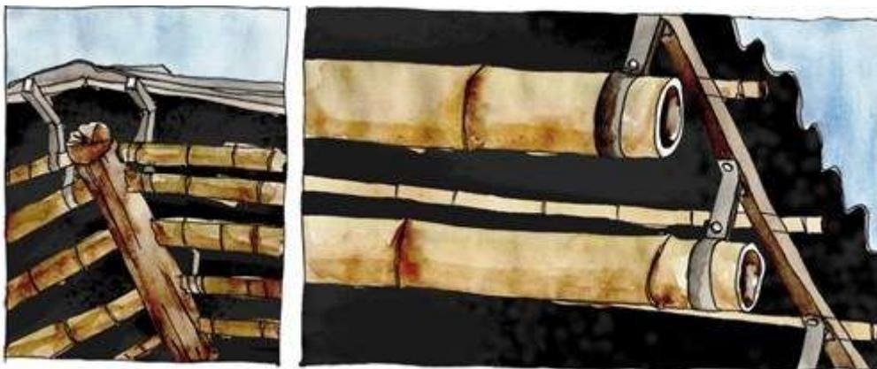
Figura 4 - Croqui demonstrando a ligação entre o bambu e as toras de madeira da estrutura.
